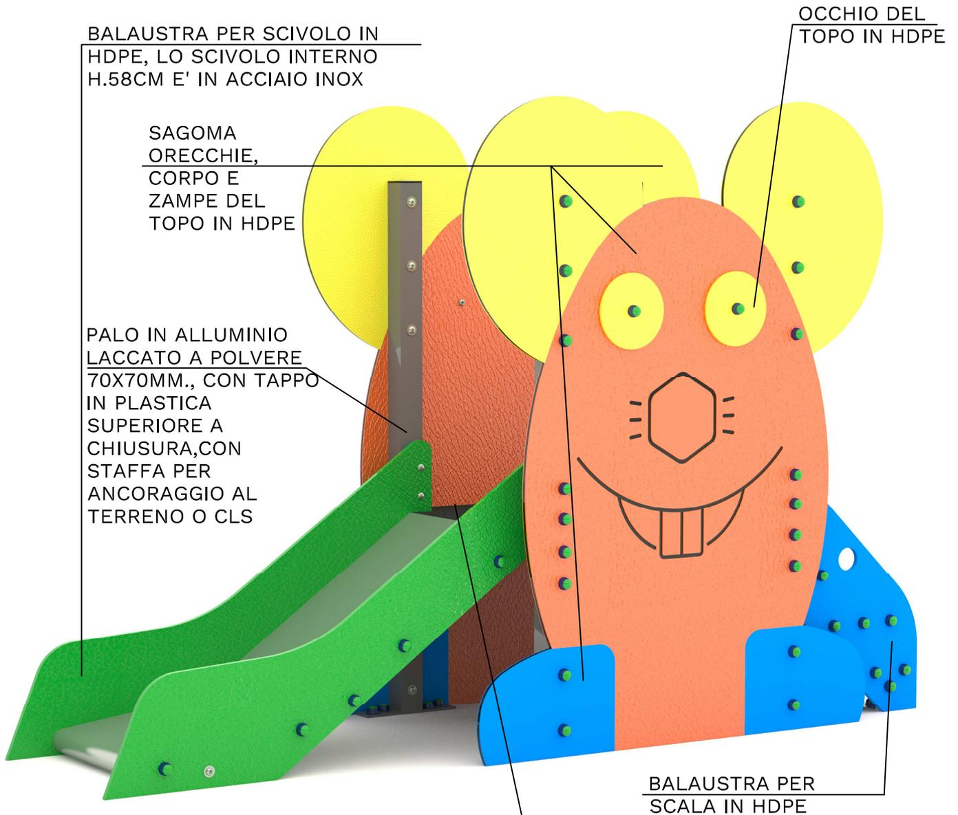
TUTTI GLI ELEMENTI DI FISSAGGIO, VITI, DADI, RONDELLE ECC. SONO IN ACCIAIO ZINCATO E PROTETTI DA GHIERE E TAPPI IN POLIETILENE.
